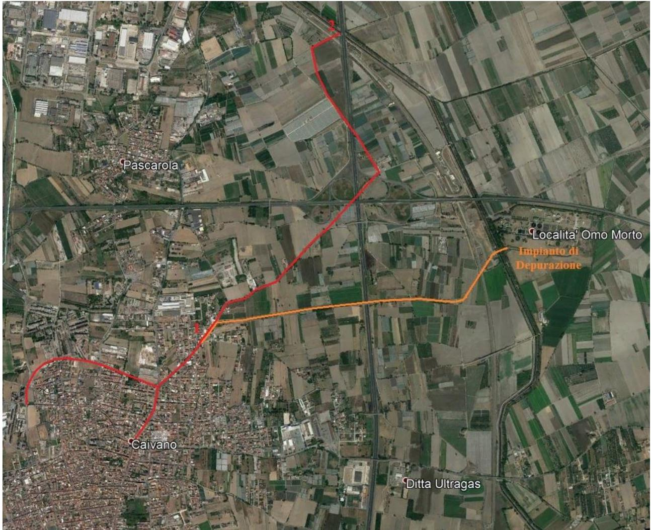
Il vecchio tracciato del canale di scolo delle acque sia piovane che luride a lato di via S. Arcangelo (in rosso da 1 a 2) e il tracciato del nuovo collettore (in arancione) che porta le acque all'impianto di depurazione del comprensorio di Acerra (in località Omo Morto a Caivano).
